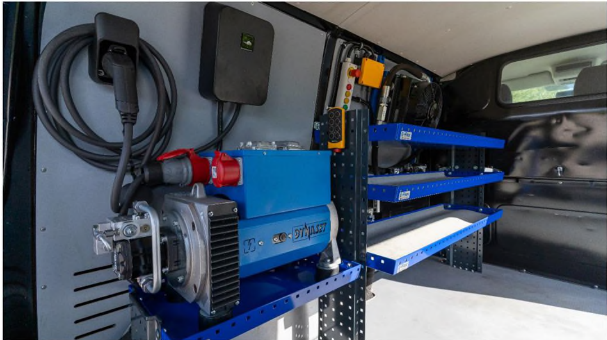
Volkswagen Transporter mit mobiler DYNASET EV-Charger S AC-Ladestation
